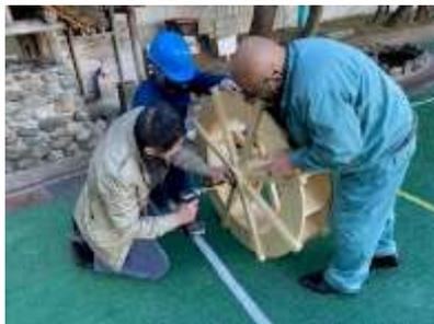
ステンレス製の軸の取り付け
